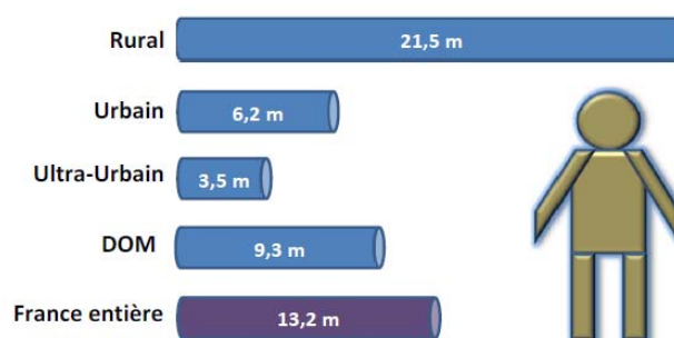
▲ Figure 1. Linéaire moyen de canalisation pour desservir un habitant suivant le type de service
